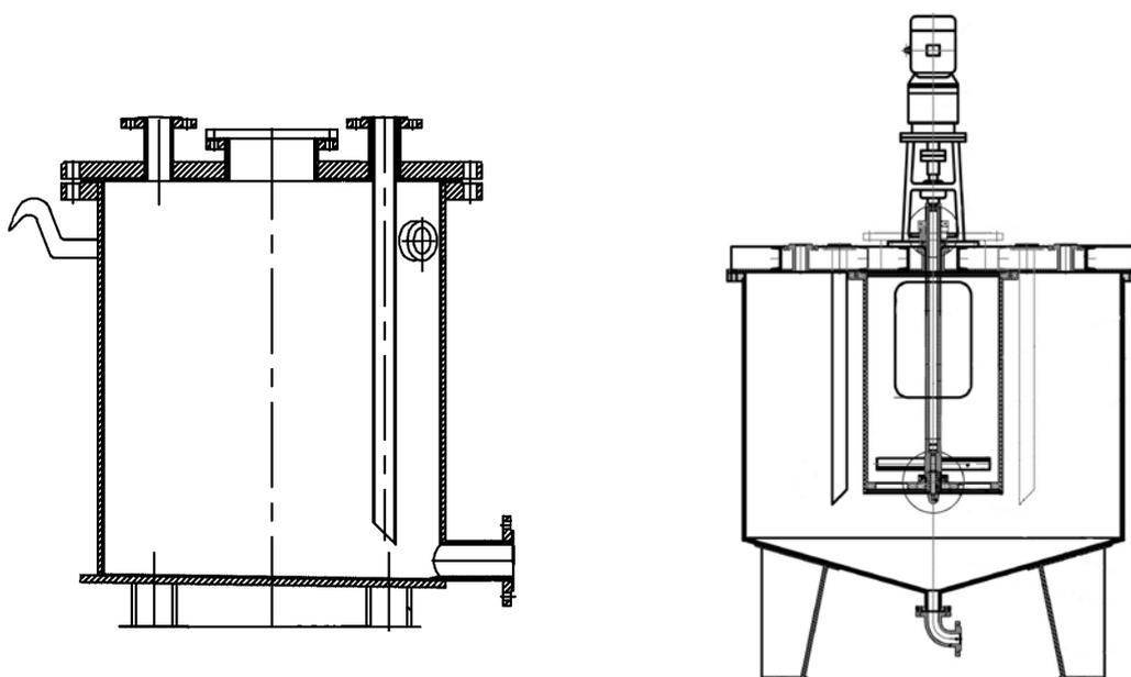
АЕП большего объема монтируются из царг диаметром до 3500 мм и высотой до 5500 мм. Футеровка – Ф-40.
